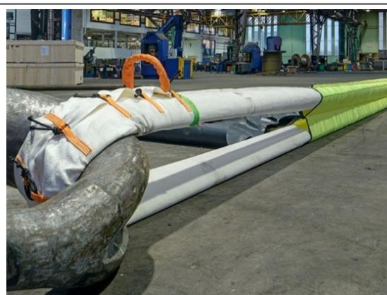
Abbildung 8: Multileg Abdeckung (X-Form)
